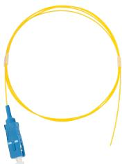
Оптические монтажные шнуры (пиг-тейлы) служат для оконцевания оптоволоконных кабелей разъемами посредством приваривания к ним готового отрезка кабеля заранее оконцованным коннектором в заводских условиях. Такие шнуры изготавливаются из кабелей диаметром 0,9 мм и, соответственно, имеют разъем лишь с одной стороны. Монтажные шнуры могут быть как одномодовыми (желтая оболочка), так и многомодовыми (оранжевая оболочка).
