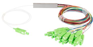
Оптические планарные сплиттеры, так же известны как PLC (Planar Lightwave Circuit) делители. Позволяют объединять и разделять мощности оптических сигналов равномерно между всеми выходами. Благодаря отсутствию потребности в электропитании, устройства получили широкое распространение в сетях, построенных на основе технологии PON и FTTx. Планарные разветвители имеют более стабильные и точные параметры по сравнению со сплавными.
