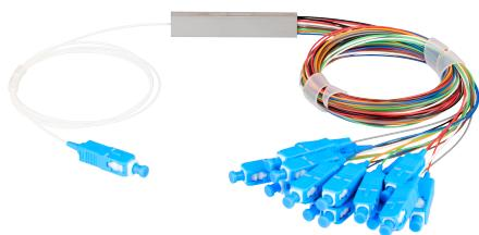
Оптические планарные сплиттеры, так же известны как PLC (Planar Lightwave Circuit) делители. Позволяют объединять и разделять мощности оптических сигналов равномерно между всеми выходами. Благодаря отсутствию потребности в электропитании, устройства получили широкое распространение в сетях, построенных на основе технологии PON и FTTx. Планарные разветвители имеют более стабильные и точные параметры по сравнению со сплавными.
