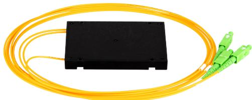
Оптические планарные сплиттеры, так же известны как PLC (Planar Lightwave Circuit) делители позволяют объединять и разделять мощности оптических сигналов равномерно между всеми выходами. Благодаря отсутствию потребности в электропитании, устройства получили широкое распространение в сетях FTTx. Планарные разветвители имеют более стабильные и точные параметры по сравнению со сплавными.
