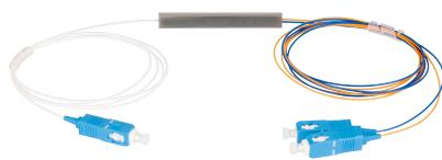
Оптические планарные сплиттеры, так же известны как PLC (Planar Lightwave Circuit) делители. Позволяют объединять и разделять мощности оптических сигналов равномерно между всеми выходами. Благодаря отсутствию потребности в электропитании, устройства получили широкое распространение в сетях, построенных на основе технологии PON и FTTx. Планарные разветвители имеют более стабильные и точные параметры по сравнению со сплавными.
