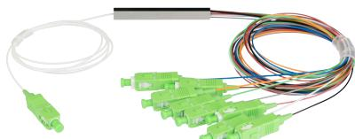
Оптические планарные сплиттеры, так же известны как PLC (Planar Lightwave Circuit) делители. Позволяют объединять и разделять мощности оптических сигналов равномерно между всеми выходами. Благодаря отсутствию потребности в электропитании, устройства получили широкое распространение в сетях, построенных на основе технологии PON и FTTx. Планарные разветвители имеют более стабильные и точные параметры по сравнению со сплавными.
