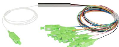
Оптические планарные сплиттеры, так же известны как PLC (Planar Lightwave Circuit) делители. Позволяют объединять и разделять мощности оптических сигналов равномерно между всеми выходами. Благодаря отсутствию потребности в электропитании, устройства получили широкое распространение в сетях, построенных на основе технологии PON и FTTx. Планарные разветвители имеют более стабильные и точные параметры по сравнению со сплавными.
