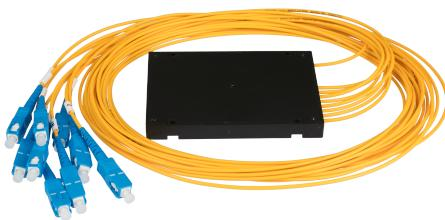
Сплиттер планарный 1x8, одномодовый, G.657.A1, SC/UPC, станд.корпус, 2 мм
