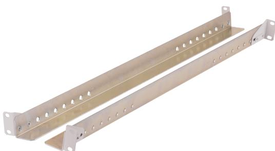
Горизонтальные направляющие предназначены для поддержки тяжелого оборудования, и устанавливаются на вертикальные монтажные направляющие шкафов и стоек с различной глубиной. Комплект — 2 шт. Конструкция направляющих позволяет регулировать глубину установки под монтажные профили шкафа. Максимальная ширина устанавливаемого оборудования 432 мм. Минимальная — 395 мм.
