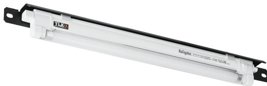
Блок освещения предназначены для местного освещения оборудования в шкафах или стойках. В блоке используются светодиодные лампы мощностью 5 Вт. Лампы дают равномерную освещенность и световой поток, превышающий лампы накаливания мощностью 40 Вт. Напряжение питания блока —220 В. Шасси и корпус блока выполнены из стали. Корпус лампы выполнен из высококачественной пластмассы серого цвета. Рассеиватель выполнен из прозрачной пластмассы.
