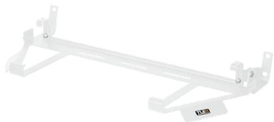
Откидывающаяся клавиатурная полка предназначена для закрепления **полноразмерной** клавиатуры шириной до 474 мм в шкафах и стойках. Конструкция полки надежно фиксирует клавиатуру, занимает мало места и легко переходит в рабочее состояние. В сложенном виде полка закрывает около 200 мм (менее 5U), что не превышает размеров одного сервера. Крепление полки осуществляется на одной паре 19" направляющих в четырех точках.
