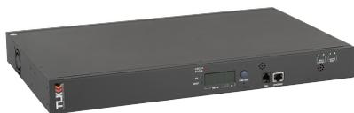
Блок TLK-RPI-AT-A10-M22-WCE-BK выполнен в 19" стандарте с высотой 1U. Блок состоит из 10 электрических розеток IEC 60320 C13. Позволяет производить управление питанием: автоматическое переключение между входными линиями. Максимальная нагрузка составляет 16А для всего блока. С тыльной стороны блока розеток расположено два разъёма IEC 60320 C20 для подключения кабеля питания NIKOMAX (может быть 1,8; 3,0; 5,0 метра). Корпус изготовлен из металла.
