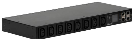
Блок контролируемых электрических розеток NIKOMAX, SW - Switched, (включение и отключение каждой розетки, измерение общего потребления и отправка показаний через LAN), 19", 8 розеток C13, макс. нагрузка 16 А, шнур питания 2 м., вилка C20, цифровое измерение силы тока на входе, защита 16А, металлический корпус, Счетчик кВт\*ч, макс. мощность 4000 Вт, 436x180x44.5 мм, цвет черный.
