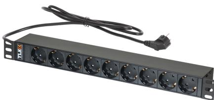
Блок электрических розеток выполнен в виде корпуса с креплением 19" и высотой 1U. Корпус изготовлен из алюминиевого профиля толщиной 1,2 мм, все элементы блока розеток имеют единый контур заземления. Использование корпуса из алюминиевого профиля обеспечивает дополнительную защиту от повреждения при случайных ударах, более высокую термостойкость, облегченную конструкцию, улучшенное охлаждение и дополнительное экранирование от электрических помех.
