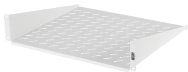
Фронтальная полка предназначена для размещения нестандартного легкого оборудования, инструментов или документации в телекоммуникационных шкафах и стойках. Поверхность полки имеет перфорацию для лучшей вентиляции оборудования. Крепление осуществляется на одной паре 19" направляющих в четырех точках за фронтальную часть полки. Полка устанавливается в напольные шкафы и стойки, настенные шкафы в соответствии с таблицей совместимости аксессуаров.
