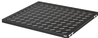
Стационарная полка **увеличенной ширины** предназначена для установки и поддержки тяжелого оборудования. Полка устанавливается в напольные шкафы серии TFA, TFM, TFI-R и настенные шкафы TWI-R, TWC-R в соответствии с разделом совместимости аксессуаров. Поверхность полки имеет перфорацию для лучшей вентиляции оборудования. Крепление осуществляется на двух парах 19" направляющих в четырех точках по боковым сторонам полки.
