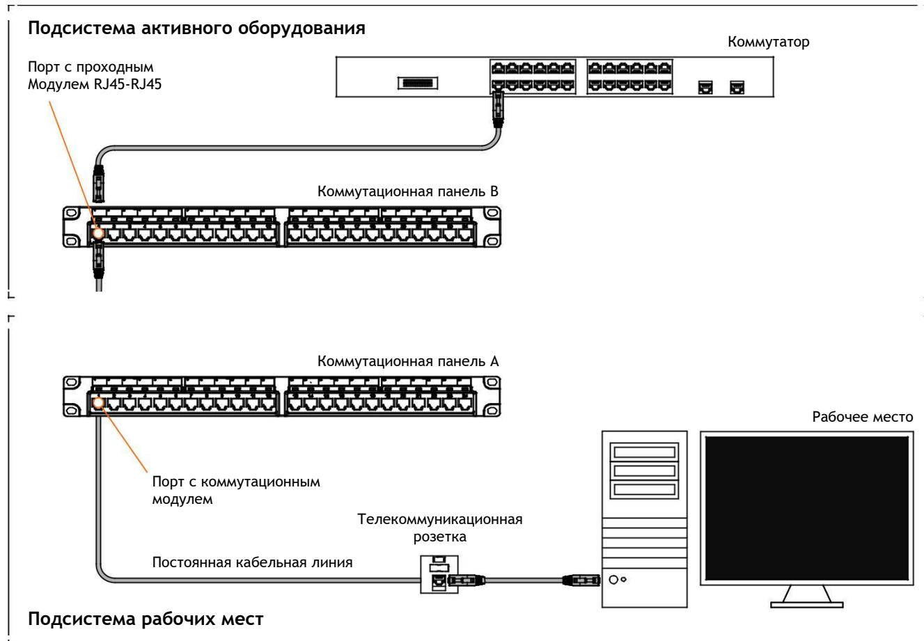
Из-за особенностей конструкции с данными панелями необходимо использовать специально модифицированные модули Keystone с индексом «LS» в артикуле. Основой для модификации послужили компоненты серии NIKOMAX Fast Termination, так что модули «LS» совместимы с инструментом для быстрой заделки NMC-FT-TOOL и доступны всех тех же типов, что и модули «FT».
