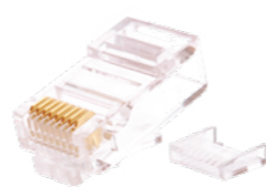
NMC-RJ88RZ50UD2-100 RJ45/8P8C, Кат.5e, UTP, 50 мкд, со вставкой, универсальные ножи, круглый ввод
