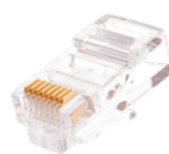
NMC-RJ88RE50UD1-100 RJ45/8P8C, Кат.5e, UTP, 50 мкд, под многожильные кабели, круглый ввод
