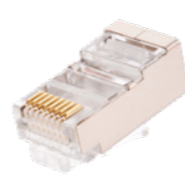
NMC-RJ88RZ50SE1-100 RJ45/8P8C, Кат.6, STP, 50 мкд, универсальные ножи, круглый ввод
