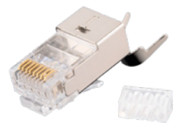
NMC-RJ88RZ50SA3-T-100 RJ45/8P8C, Кат.6 A , STP, 50 мкд, со вставкой, универсальные ножи, с хвостовиком
