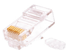
NMC-RJ88RZ50UE3-100 RJ45/8P8C, Кат.6, UTP, 50 мкд, со вставкой, универсальные ножи, круглый ввод
