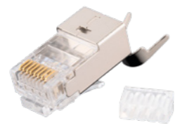
NMC-RJ88RZ50SE3-T-100 RJ45/8P8C, Кат.6, STP, 50 мкд, со вставкой, универсальные ножи, с хвостовиком
